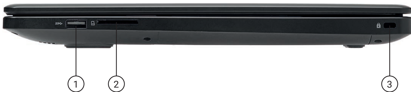
Рисунок 4 – Расположение компонентов Изделия (вид справа)
