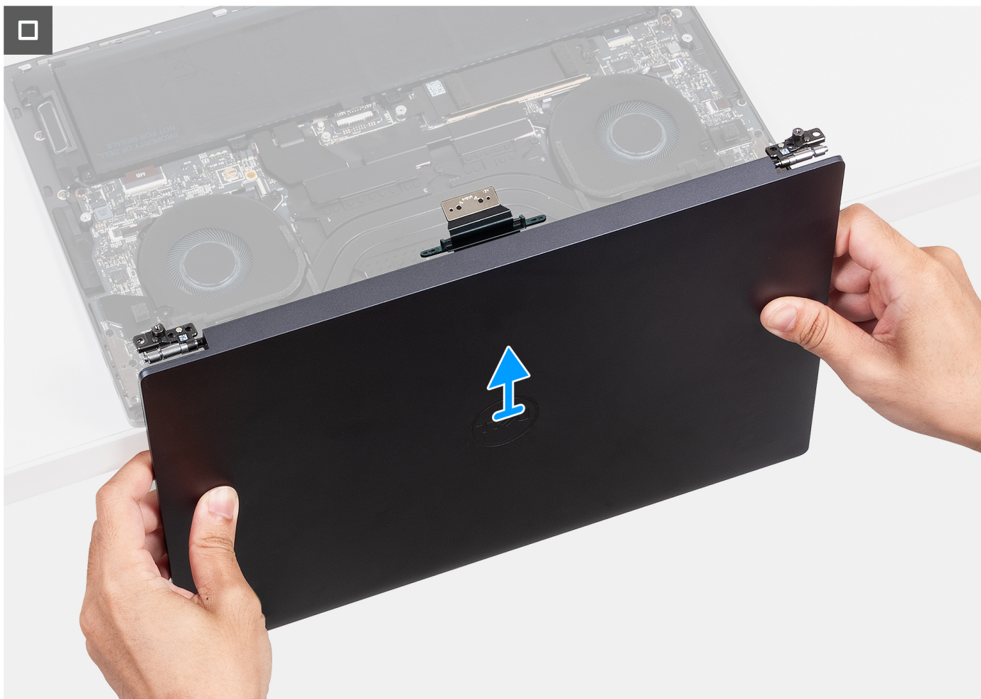
Рисунок 28. Снятие дисплея в сборе
