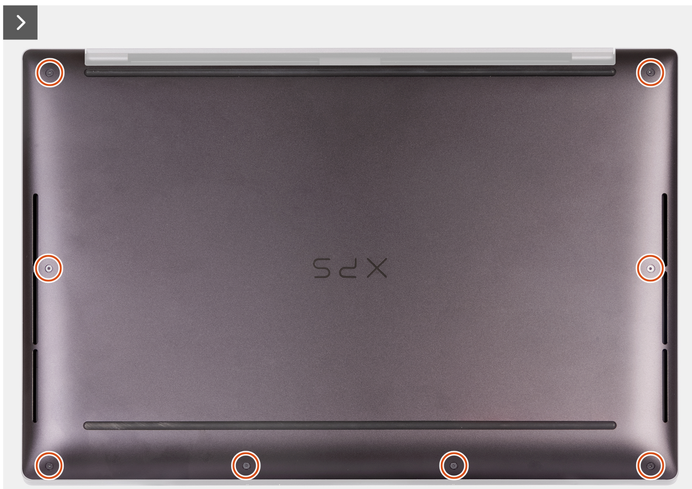
Рисунок 9. Снятие нижней крышки
