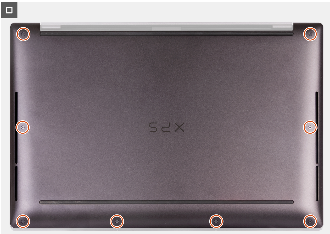
Рисунок 16. Затяните восемь винтов, чтобы прикрепить нижнюю крышку к опорной панели в сборе
