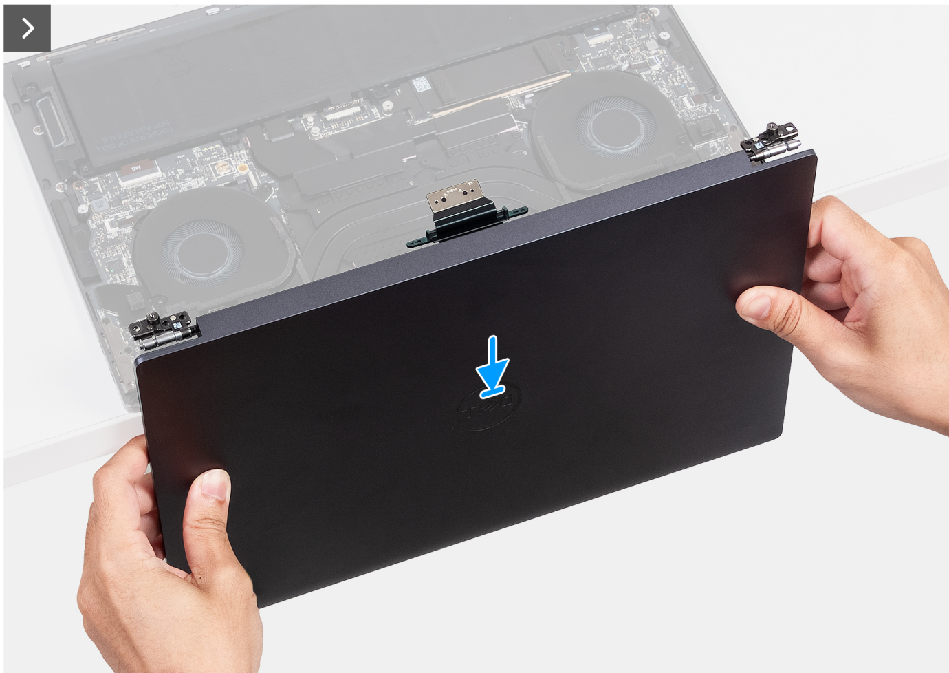
Рисунок 30. Установка дисплея в сборе
