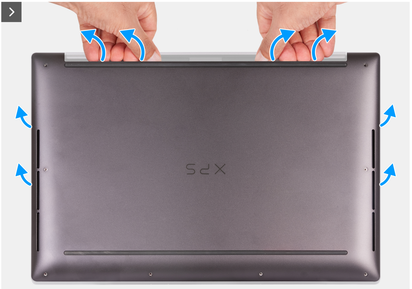
Рисунок 10. Использование больших пальцев обеих рук для поддевания нижней крышки
