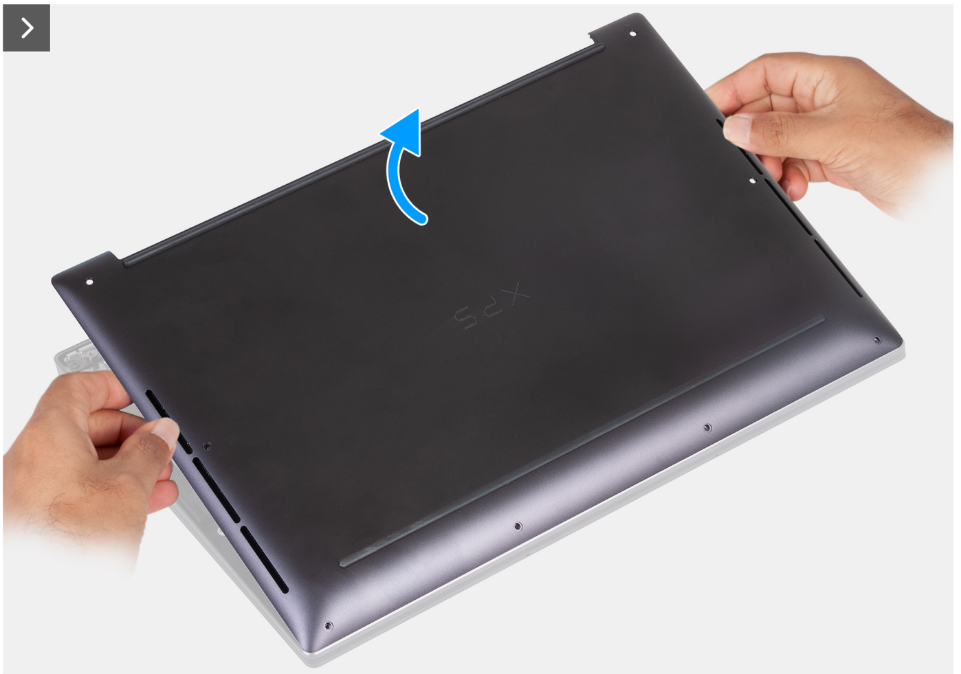
Рисунок 11. Снятие нижней крышки с опорной панели в сборе
