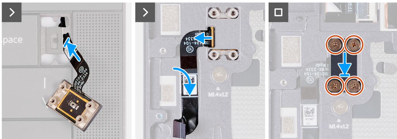
Рисунок 40. Установка кнопки питания со сканером отпечатка пальца
