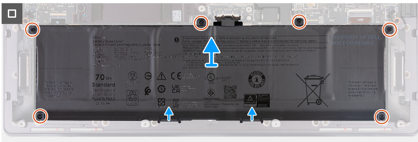
Рисунок 17. Извлечение аккумулятора
