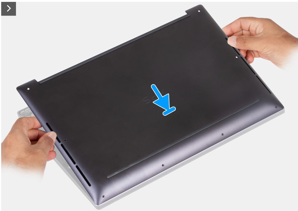
Рисунок 14. Установка нижней крышки в пазы на опорной панели в сборе
